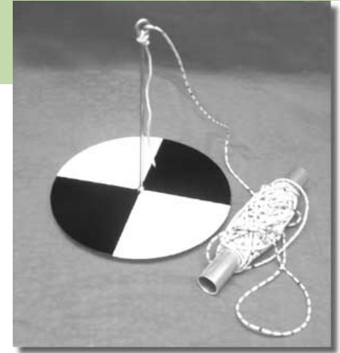
MEDIÇÃO DA TRANSPARÊNCIA DA ÁGUA COM DISCO DE SECCHI
